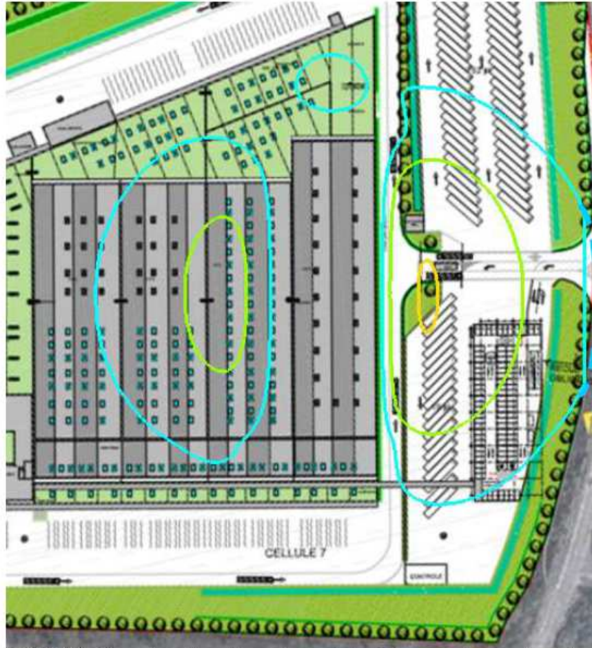
Figure 4-13 : Incendie cellule HBW seule : Flux thermiques à 5 mètres au-dessus du sol avec mur REI 240 de 8 m de haut en façade Est
